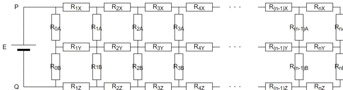
回路は上下で線対称なので物理的に、上下の対応する点において電圧や電流は等しくなる。このこと、特に抵抗  $R_{0A}, R_{0B}$  に流れる電流は等しいことを踏まえて、 $R_{0A}, R_{0B}$  の間の点について考える。抵抗  $R_{0A}, R_{0B}$  に流れる電流を  $I_0$  としたとき、 $R_{0A}, R_{0B}$  の間の点について、キルヒホッフの第一法則（流入する電流と流出する電流の大きさは等しい）を考えると、右側（抵抗  $R_{1Y}$ ）には電流が流れないことがわかる。故に、この抵抗は取り除いてよく、これをドミノ倒しのように繰り返すことで  $R_{iY}$  には電流が流れないことがわかる。
