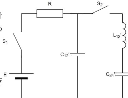
電気振動で交流電流が流れるとみなして、キルヒホッフの法則を適用する。コンデンサ 1,2、コイル 1 のインピーダンス (複素数表示) はそれぞれ
